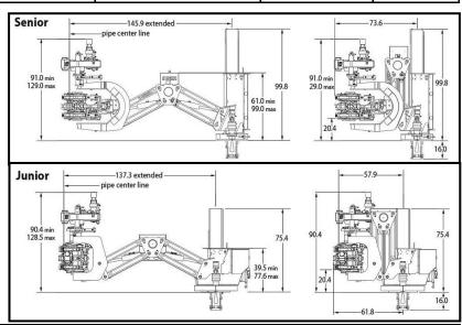
ADD 6' TO HEIGHT FOR RAISE/LOWER CYLINDER — LIFTING BALANCE SCREW
